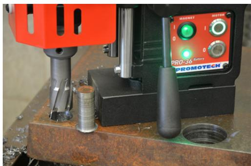
Capacidad de fresado de hasta 36 mm
