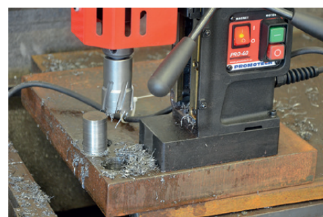
Foratura con frese a corona sino a 40 mm Profondità massima fino a 50 mm
