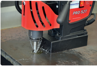
Maschiatura fori passanti sino a M20
