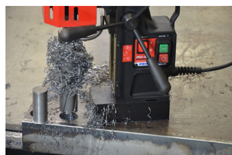
Foratura con frese a corona sino a 45 mm Profondità massima fino a 75 mm - /opzionale/
