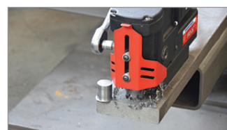
Capacità max di fresatura fino a 36 mm
