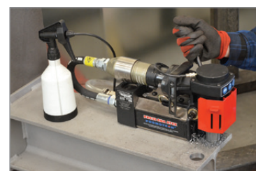
Sistema di raffreddamento attraverso il mandrino
