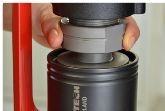
Mandrino per maschiatura con ghiera di sicurezza
