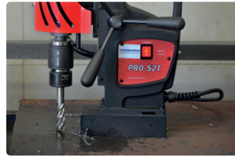
Maschiatura fori ciechi sino a M20
