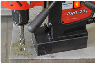
Maschiatura fori passanti sino a M20
