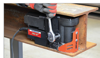
Design compatto per luoghi dall'altezza limitata. La leva d'avanzamento scollegabile (dotata di cricchetto) può essere fissata su entrambi i lati.
