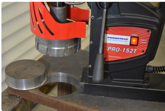
Foratura con frese a corona max 150 mm
