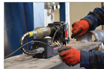
Leva d'avanzamento fissabile su entrambi i lati
