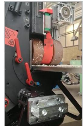
Die ABM-50 hat sich als zuverlässiger und effizienter Schweißkantenformer unter den anspruchsvollsten Arbeitsbedingungen, einschließlich hoher Temperaturen und Feuchtigkeit, bewährt.
