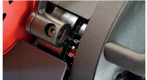
Präzise Einstellung des Fasenwinkels
