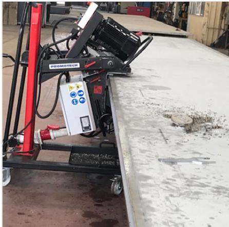
Die 180°-Umkehrung der ABM-50 ermöglicht ein beidseitiges Fasen, die das Wenden langer und schwerer Platten überflüssig macht.
