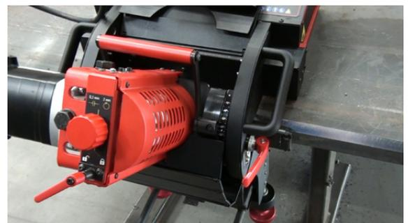
Innovatives und ergonomisches System zur Einstellung des Fasenwinkels mit Entriegelungshebel. Erfordert kein zusätzliches Werkzeug
