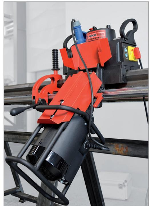
Die ABM-28 kann in beide Fahrrichtungen entlang der Stahlplattenkante fasen, wodurch der Arbeitsaufwand deutlich reduziert wird. Die erforderliche Länge der Führungsbahn (Schiene) kann mit zusätzlichen Abschnitten der Führungsbahnen erreicht werden.
