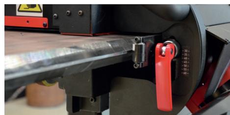
Cómodo ajuste al espesor de la chapa
