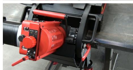
Innovador y ergonómico sistema de ajuste del ángulo de bisel con palanca de desbloqueo que no requiere herramientas adicionales
