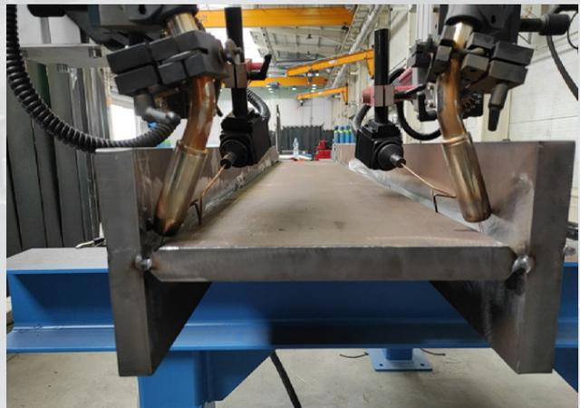
Die Taktile-Nahtverfolgung von PROMOTECH gewährleistet eine korrekte und wiederholbare Brennerposition während des gesamten Schweißprozesses.
