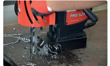
Foratura con punte elicoidali max 23 mm
