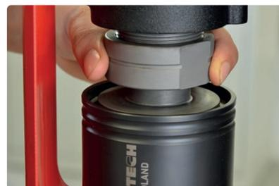
Il mandrino per maschiatura dotato di dado di fissaggio protegge l'utensile per maschiatura durante l'estrazione
