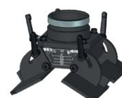
Accesorio para la eliminación de juntas soldadas de superficies longitudinales y circunferenciales (mín. DE 200 mm, mín. DI 400 mm) con ajuste angular de -10 a +30 grados enroscado a la superficie cilíndrica.
