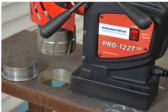
Fräskapazität bis zu 120 mm
