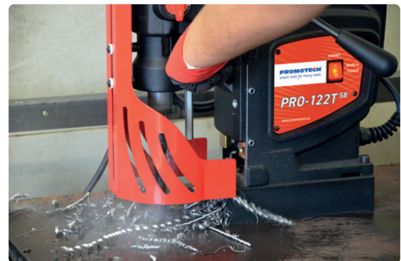
Bohrleistung bis zu 31,75 mm Max. Hub bis zu 225 mm
