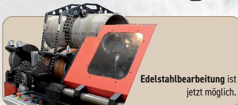
Die Verwendung des Hochleistungsfräskopfes in PRO 40 PBS bietet im Vergleich zur herkömmlichen Einzelpunktbearbeitung genaue Anfasungen in einem Bruchteil der Zeit. Diese Funktion spart Zeit und Geld durch hervorragende Effizienz.
