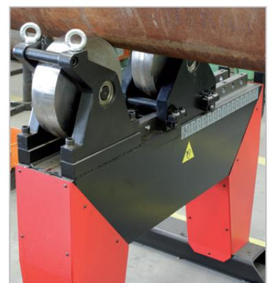
Hochleistungs-Einstellrohr Stütze (Ø 200-1000 mm)
