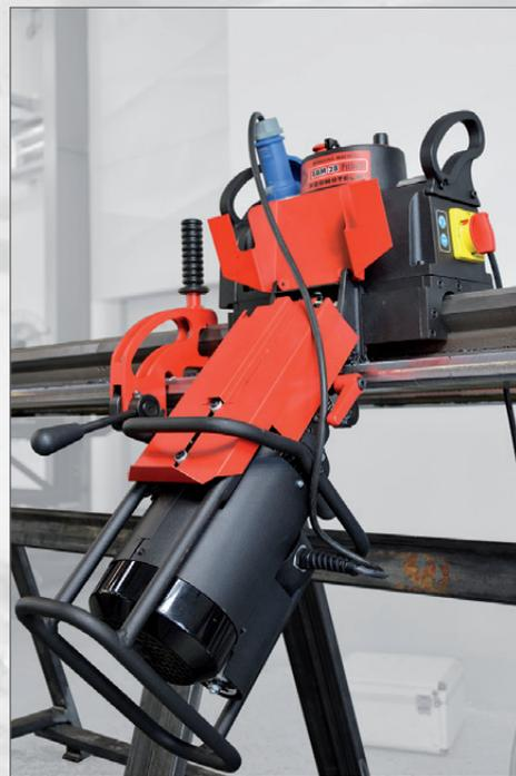
Die ABM-28 kann in beide Fahrrichtungen entlang der Stahlplattenkante fasen, wodurch der Arbeitsaufwand deutlich reduziert wird.
