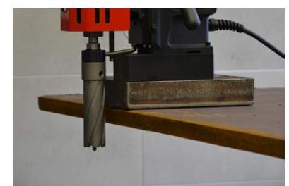
Startpunkt der Bohrung bis 50 mm unter dem Niveau des Bohrsockels mit 100 mm langem Fräse
