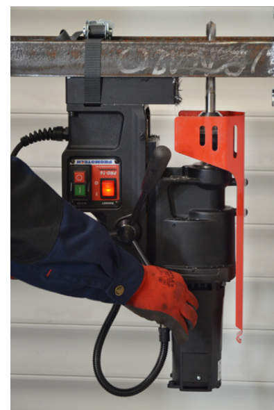
Possibilità di forare fino a 50 mm sotto il livello della lamiera tramite una fresa lunga 100 mm
