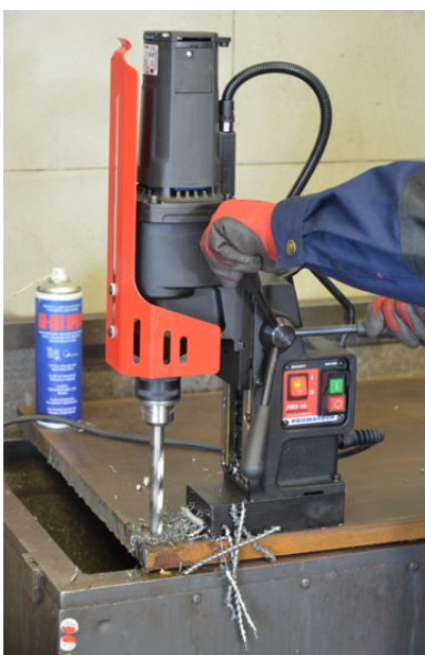
Adattatore 3/4" x 1/2" 20 UNF, mandrino per punte elicoidali 1/2" 20 UNF
