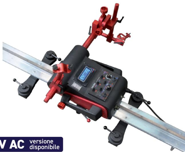
Rail Bull può spostarsi lungo una guida rigida o semi-flessibile su materiali ferromagnetici e non ferromagnetici grazie all'azionamento a cremagliera e a guide fissate su superfici piane o curve mediante diverse unità magnetiche a depressione.
