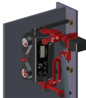
Saldatura d'angolo con oscillatore
