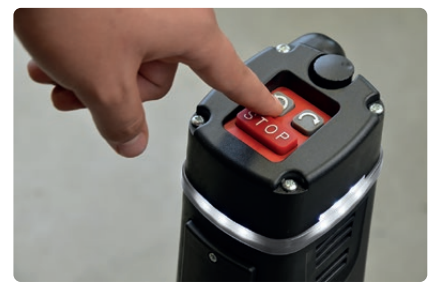
Linkslauf (linksdrehend) Benutzerfreundliche Steuerung der Gewindeschneidwerkzeugaube
