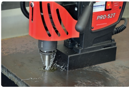
Maschiatura fori passanti sino a M20
