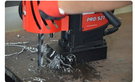
Foratura con punte elicoidali max 23 mm (7/8") • Corsa 190 mm (7-1/2")
