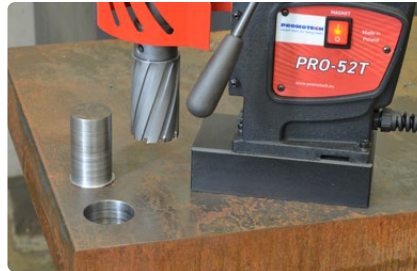
Foratura con frese a corona sino a 50 mm (2") • Profondità max. sino a 75 mm (3")
