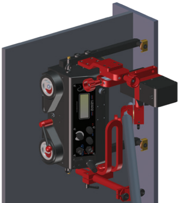
Soudage d'angle avec oscillateur
