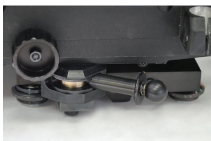
Лост за заключване на трактора към релсата
