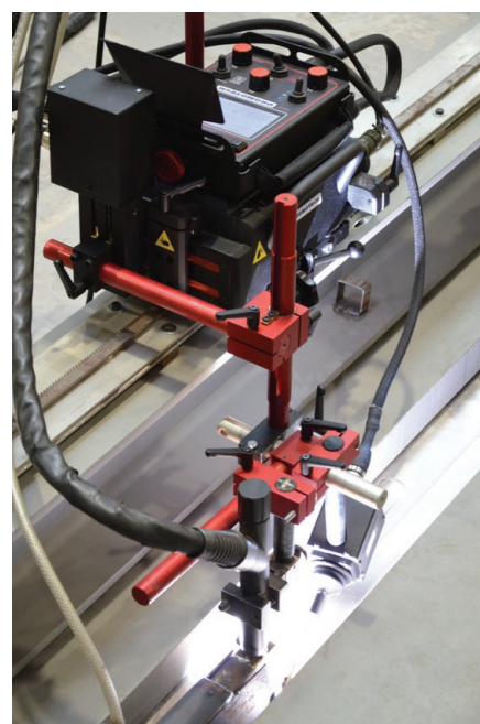
Следяща система за автоматична корекция на положението на горелката, работи с и без осцилация
