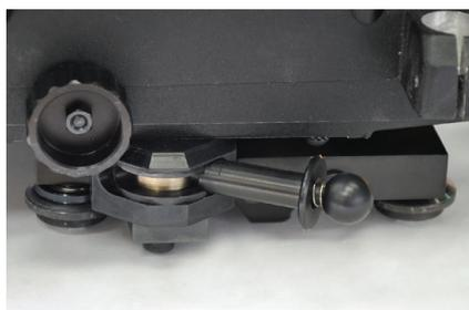
Alavanca de aperto rápido para posicionar o Rail Titan na calha
