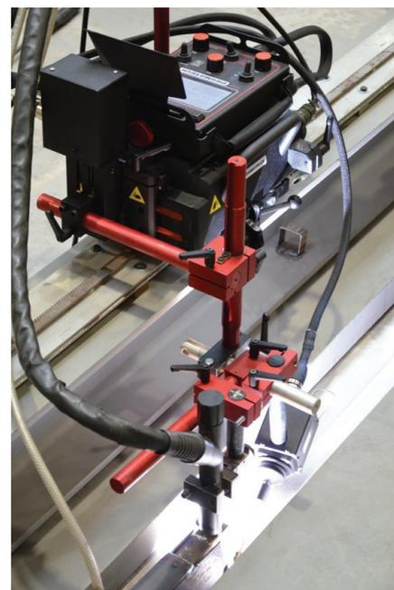
O seguimento de junta funciona com e sem oscilação
