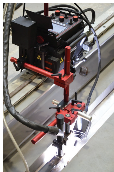
Lasnaad volgsysteem werkt met en zonder oscillatie
