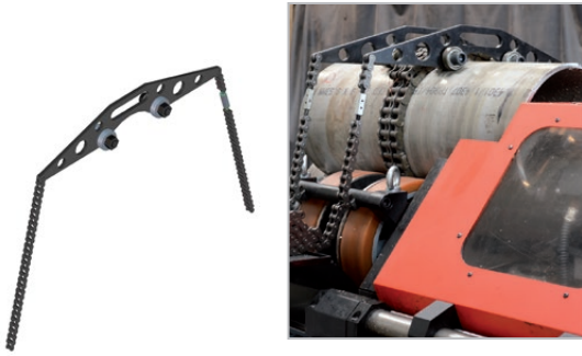
DCS-0436-99-00-00-0 Spannvorrichtung für kurze Rohre von 400-830 mm Länge
