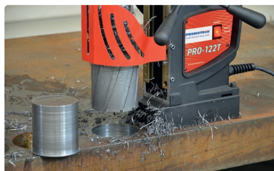
Maximale Schnitttiefe bis zu 100 mm
