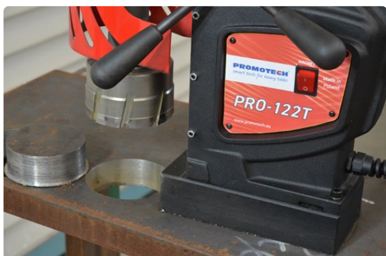
Fräskapazität bis zu 120 mm
