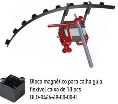
Bloco magnético para calha guia flexível caixa de 10 pcs
