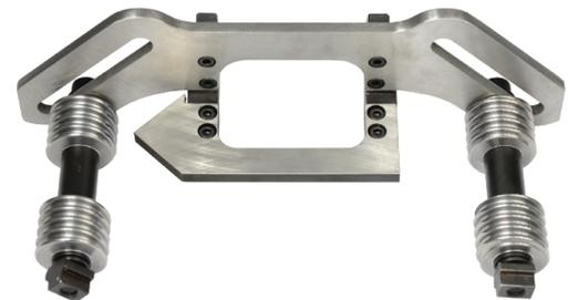
Guide standard universel pour le chanfreinage de tôles plates et tubes  $\varnothing$  150-300mm (6-12")
