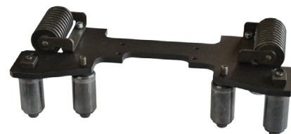
Attacco per la smussatura di lastre rotonde: Raggio esterno minimo R = 1000 mm (40") Raggio interno minimo R = 1000 mm (40") Larghezza max di smusso 19 mm Codice prodotto: ZSP-0539-10-00-00-0
