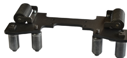
Afschuin hulpstuk voor ronde plaat Minimale radius buiten R=1000 mm Minimale radius binnen R=1000 mm Max. afschuin breedte 19 mm Product code: ZSP-0539-10-00-00-0
