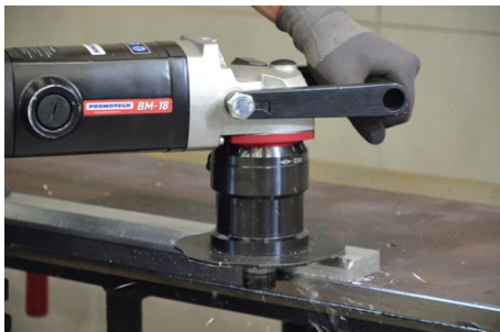
アルミ材の開先加工
