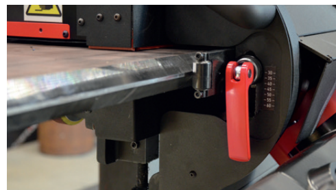
Comoda regolazione dello spessore della piastra
