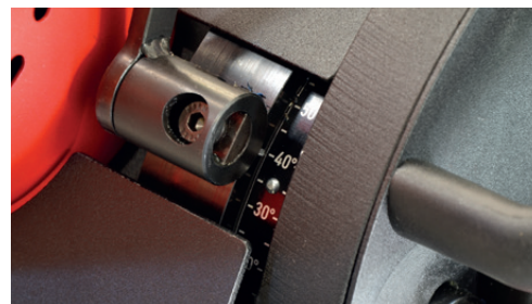
Impostazione precisa dell'angolo di smussatura
