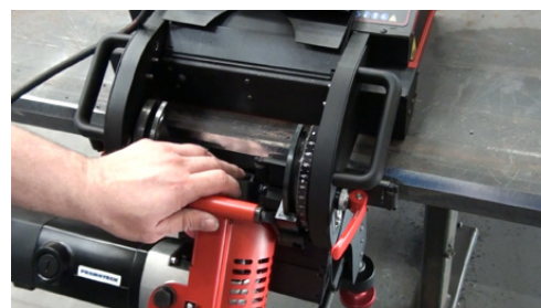
Comoda regolazione dello spessore della piastra
