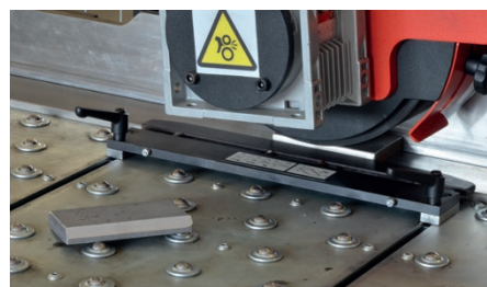
Dispositivo per pezzi stretti
