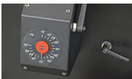
Regolazione precisa dell'angolo di smusso
