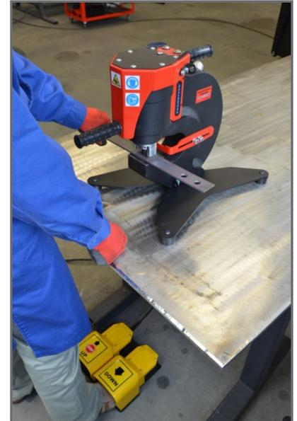
Fußschaltersteuerung ermöglicht Freihandbetrieb in der Tischposition.
