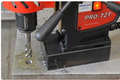
Maschiatura fori passanti sino a M20
