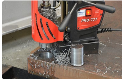
Foratura con frese a corona sino a 70 mm (2-3/4") • Profondità max. sino a 75 mm (3")
