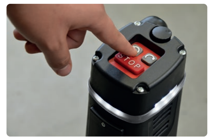
Rotazione antioraria (CCW) Controllo semplice ed intuitivo del sistema di sgancio rapido per la maschiatura
