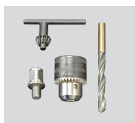
Adattatore 3/4" x 1/2" 20 UNF, mandrino per punte elicoidali 1/2" 20 UNF Foratura con punte elicoidali sino a \Phi 11.8 mm (DIN 338)
