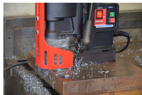
Foratura con frese a corona sino a 55 mm Profondità massima fino a 75 mm
