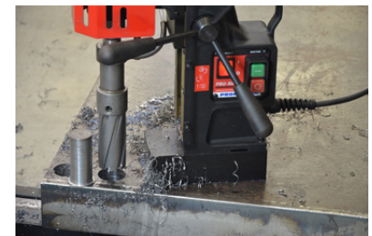
Foratura con frese a corona sino a 55 mm Profondità massima fino a 75 mm
