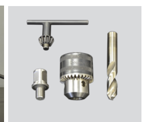
Adattatore 3/4" x 1/2" 20 UNF, mandrino per punte elicoidali 1/2" 20 UNF Foratura con punte elicoidali sino a \Phi 16.0 mm (DIN 1897)
