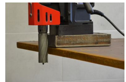
Possibilità di forare fino a 50 mm sotto il livello della lamiera tramite una fresa lunga 100 mm
