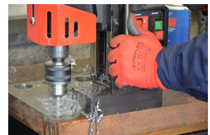
Capacità di foratura fino a 16 mm (0,63") - con punta elicoidale a gambo cilindrico Capacità di foratura fino a 23 mm (0,91") - con punta elicoidale MT2
