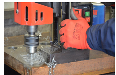
Spiraalboor capaciteit tot 16 mm met cilindrische schacht spiraalboor in gebruik Spiraalboor capaciteit tot 23 mm met MT2 schacht spiraalboor in gebruik
