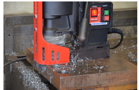
Kernboor max 55 mm Max frees diepte 75 mm
