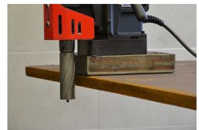
Startpunt van het boren tot 50 mm onder het niveau van een boorbasis met 100 mm lange frees
