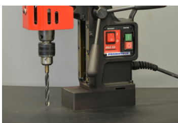
Adapter 3/4" x 1/2" 20 UNF, Boorhouder 1/2" 20 UNF Spiraalboor tot \Phi 11.8 mm (DIN 338)
