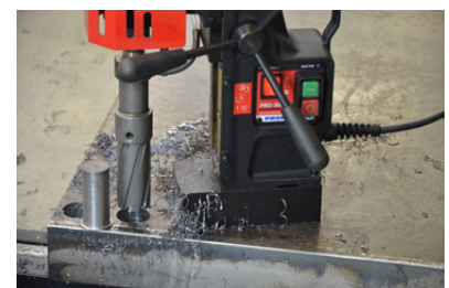
Kernboor max 55 mm Max frees diepte 75 mm
