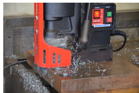
Maximale Fräskapazität bis zu 55 mm Maximale Schnitttiefe bis zu 75 mm
