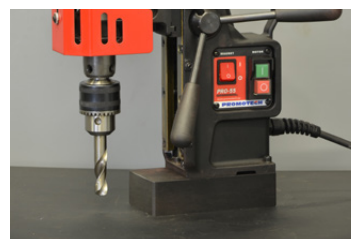
Adapter 3/4" x 1/2" 20 UNF, Bohrfutter 1/2" 20 UNF Spiralbohrer bis zu \Phi 16.0 mm (DIN 1897)
