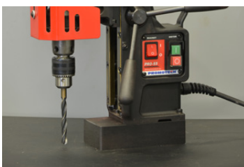
Adapter 3/4" x 1/2" 20 UNF, Bohrfutter 1/2" 20 UNF Spiralbohrer bis zu \Phi 11.8 mm (DIN 338)
