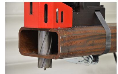
Startpunt van het boren tot 50 mm onder het niveau van een boorbasis
