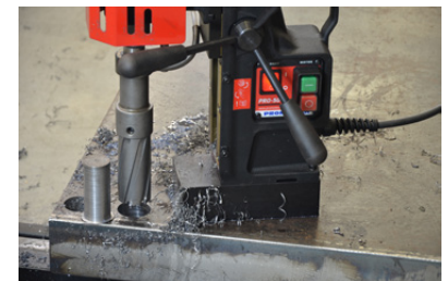
Kernboor max 55 mm Max frees diepte 75 mm
