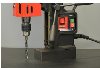
Adattatore 3/4" x 1/2" 20 UNF, mandrino per punte elicoidali 1/2" 20 UNF Foratura con punte elicoidali sino a \Phi 11.8 mm (DIN 338)
