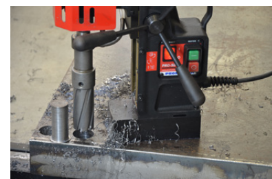
Foratura con frese a corona sino a 55 mm Profondità massima fino a 75 mm
