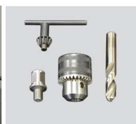
Adattatore 3/4" x 1/2" 20 UNF, mandrino per punte elicoidali 1/2" 20 UNF Foratura con punte elicoidali sino a \Phi 16.0 mm (DIN 1897)
