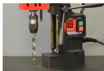
Adattatore MT2 x 1/2" 20 UNF, mandrino a serraggio rapido 1/2" 20 UNF Foratura con punte elicoidali sino a \Phi 16.0 mm (DIN 338)
