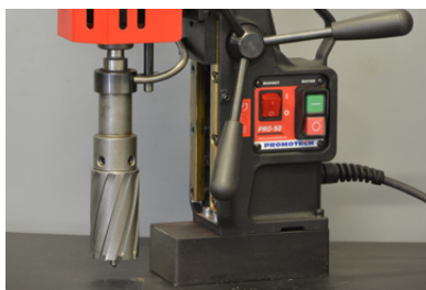
Frese TCT fino a \Phi 50 mm con Albero AMT2-C19/2-3 per 75 mm (3") profondità taglio
