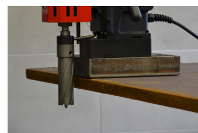
Possibilità di forare fino a 50 mm sotto il livello della lamiera tramite una frese lunga 100 mm
