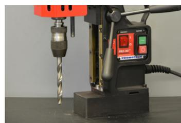
Adapter MT2 x 1/2" 20 UNF, Schnellwechsel-Bohrfutter 1/2" 20 UNF
