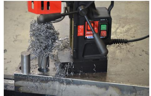
Maximale Fräskapazität bis zu 45 mm
