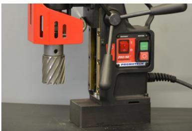
HSS-Fräser bis  $\Phi$  40 mm
