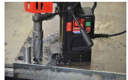
Maximale Fräskapazität bis zu 55 mm
