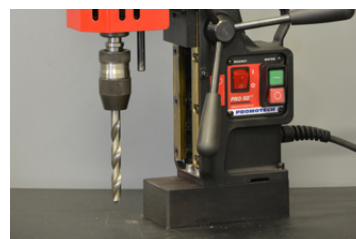
Adapter MT2 x 1/2" 20 UNF, snelwissel boorhouder 1/2" 20 UNF Spiraalboor tot \Phi 16.0 mm (DIN 338)
