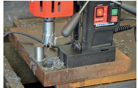
Maximale Fräskapazität bis zu 40 mm
