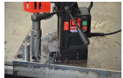
Maximale Fräskapazität bis zu 55 mm
