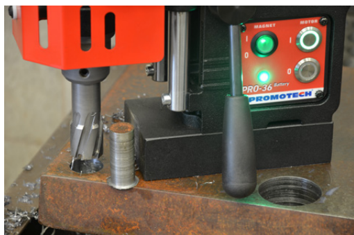
Foratura con frese a corona sino a 36 mm Profondità max. sino a 50 mm
