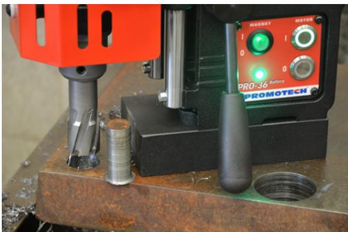
Maximale Fräskapazität bis zu 36 mm
