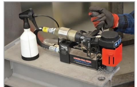
Kühlsystem durch die Spindel
