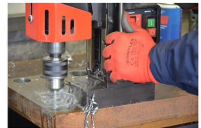
Bohrleistung bis zu 16 mm
