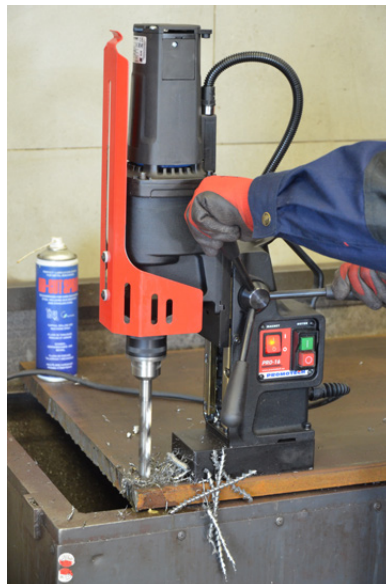
Adapter 3/4" x 1/2" 20 UNF, Boorhouder 1/2" 20 UNF Spiraalboor tot \Phi 11.8 mm (DIN 338)
