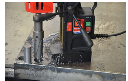
Kernboor max 55 mm Max frees diepte 75 mm
