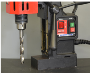
Adapter 3/4" x 1/2" 20 UNF, Boorhouder 1/2" 20 UNF Spiraalboor tot \Phi 11.8 mm (DIN 338)
