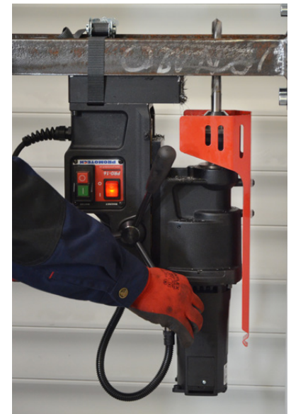
Startpunt van het boren tot 50 mm onder het niveau van een boorbasis
