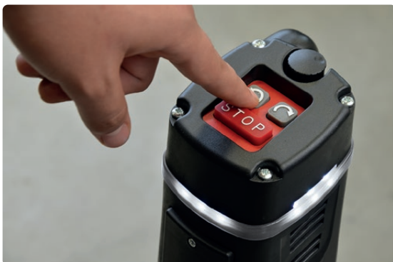
Linksom draaien (CCW counter clockwise) rotatie. Gebruiksvriendelijke bediening voor het terugdraaien tagereedschap
