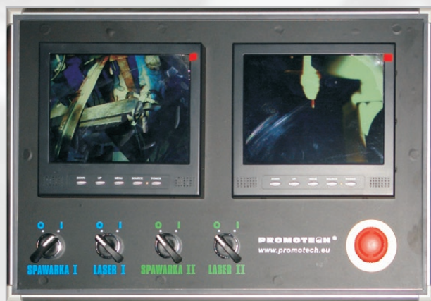
L'equipaggiamento opzionale include: sistema di telecamere per GMAW / SAW, correzione automatica della posizione della torcia di saldatura o controllo remoto.
