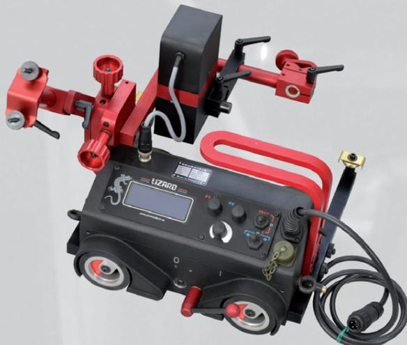
Une option très importante du LIZARD est le dispositif oscillation pour produire des soudures avec balayage. Le chariot identifie automatiquement la connexion et propose des modes de fonctionnement adaptés.
