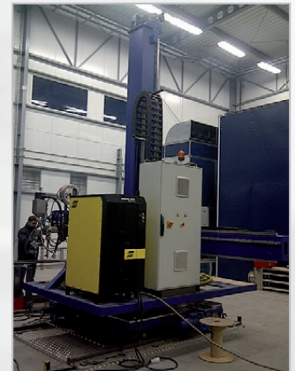
Halbbrücken-Schweißsystem zum Schweißen von Balken und Tanks Typ WA mit LINCOLN ELECTRIC PW AC/DC 1000 SD
