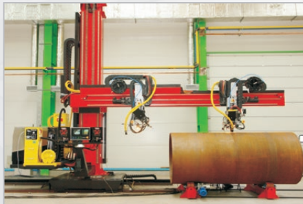
Montage und Inbetriebnahme des Kreuzmasts am Kundenstandort.
