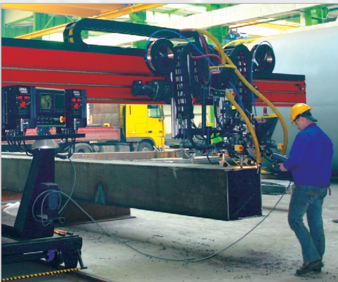
Standard-Kreuzmast mit ESAB Aristo 1000 AC/DC
