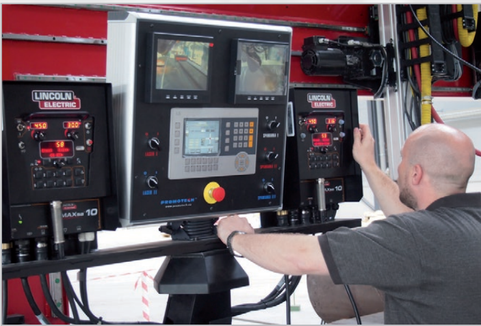
Halbbrücken-Schweißsystem zum Schweißen von Balken und Tanks Typ WA mit LINCOLN ELECTRIC PW AC/DC 1000 SD
