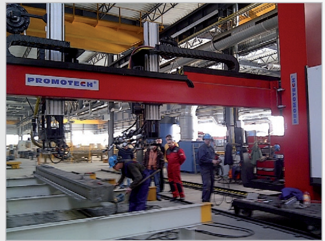
Halbbrücken-Schweißsystem zum Schweißen von Balken und Tanks Typ WA mit LINCOLN ELECTRIC PW AC/DC 1000 SD
