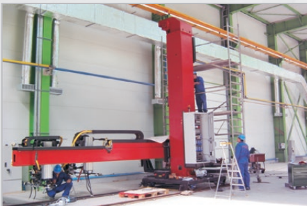
Montage und Inbetriebnahme des Kreuzmasts am Kundenstandort.
