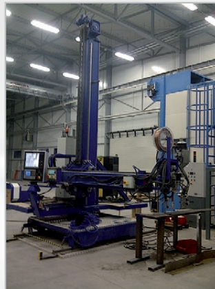
Standard-Kreuzmast mit ESAB Aristo 1000 AC/DC
