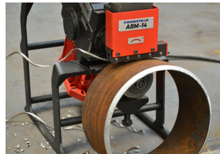
Скосяване на овални детайли и скосяване на тръби
