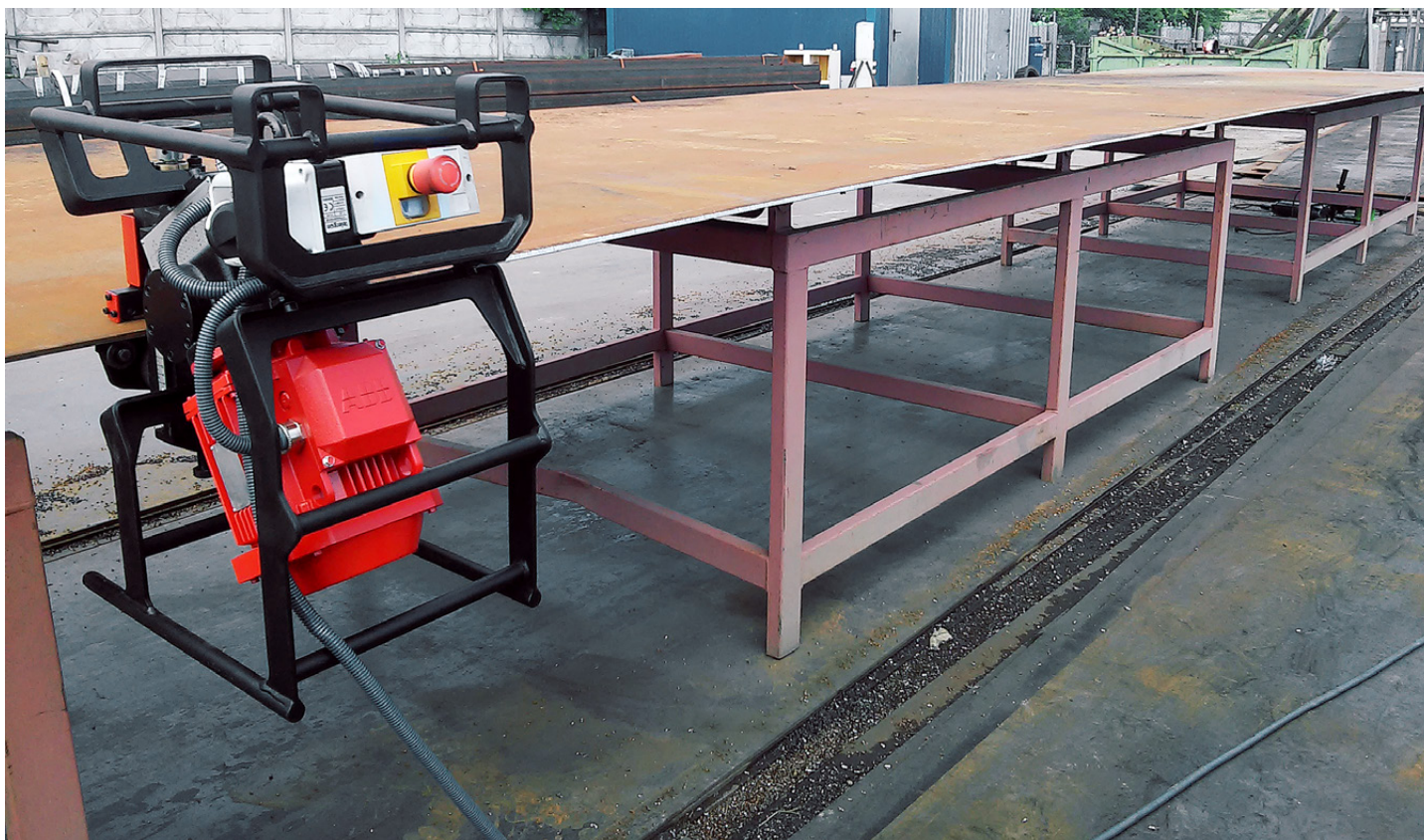
ABM-14 се движи по скосявания детайл автоматично
