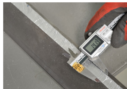
Максимална ширина на скосяване до 14 мм
