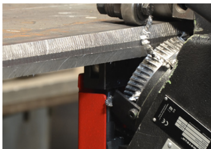
Smussatura del lato inferiore di lastre
